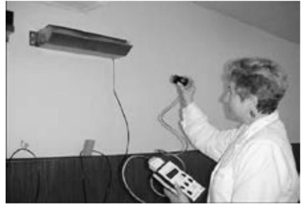
Hình 9. Đo hiệu suất của các GUV 254 và Người thực hiện đo phải đeo kính bảo vệ mắt trong quá trình đo
